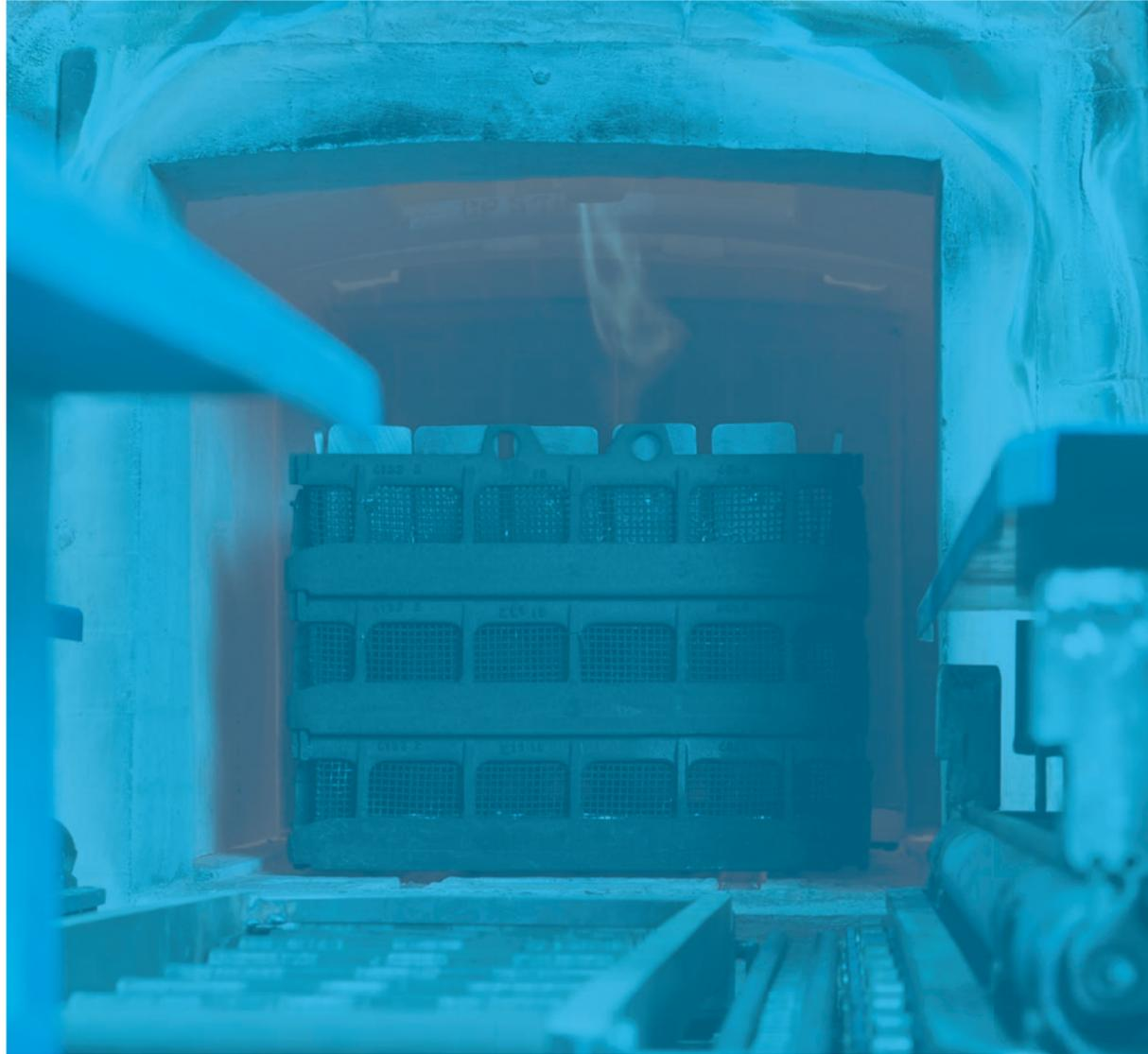
! Die Verfahren Einsatzhärten und Carbonitrieren zählen zu den thermochemischen Wärmebehandlungsverfahren. Beim Einsatzhärten wird Kohlenstoff und beim Carbonitrieren Kohlenstoff und Stickstoff in die Randschicht eindiffundiert, und damit eine Härtung der Randschicht erst möglich gemacht.
