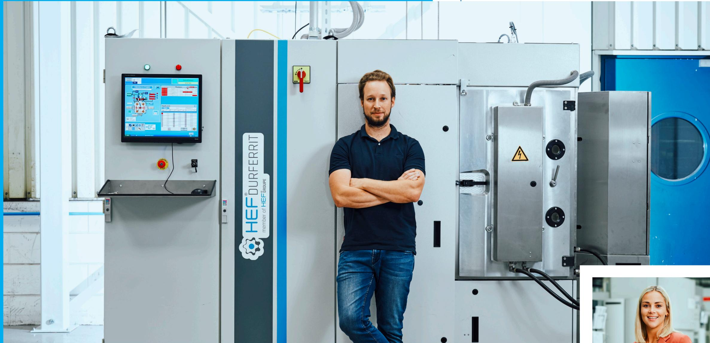
Die neue Anlage für DLC-Beschichtungen: In ihrem Inneren werden die Werkzeugoberflächen mit einer kohlenstoffhaltigen, diamantartigen Beschichtung bedampft.
